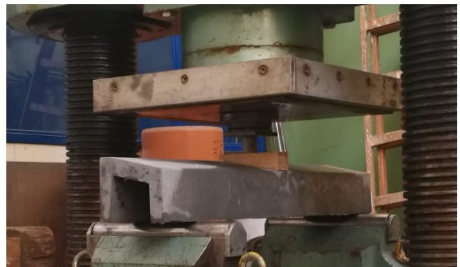
Obr. 6: zkoušení pevnosti v ohybu 2
